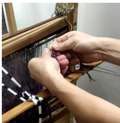
Figura 29 – Processo de enfiamento da teia no tear. Fonte: Luana Silva.
