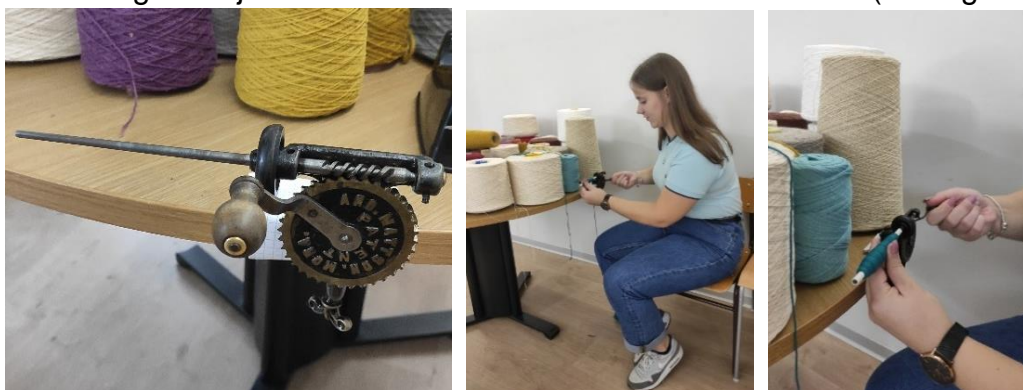
Figura 46 – Da esquerda para a direita: Roldana. Processo de enrolamento do fio na canela, realizado pela mestranda. Fonte: Luana Silva.
