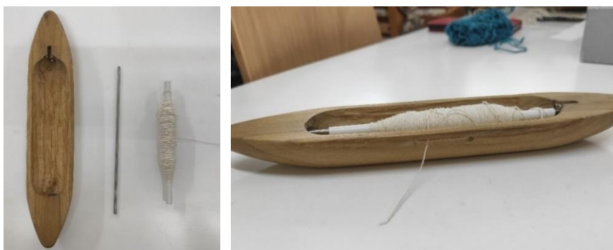
Figura 47 – Da esquerda para a direita: Peças que constituem a lançadeira, (lançadeira, ferro e canela). Lançadeira pronta para tecer. Fonte: Luana Silva.
