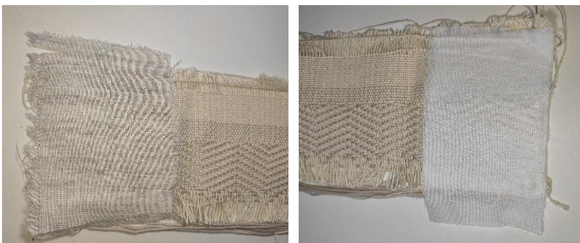
Figura 51 – Da esquerda para a direita: Experiência realizada com entretelas sobre o tecido feito no tear (experiência 2, ver Figura 49). Entretela grossa usada nos casacos de Inverno. Entretela utilizada em tecidos mais finos. Fonte: Luana Silva.
