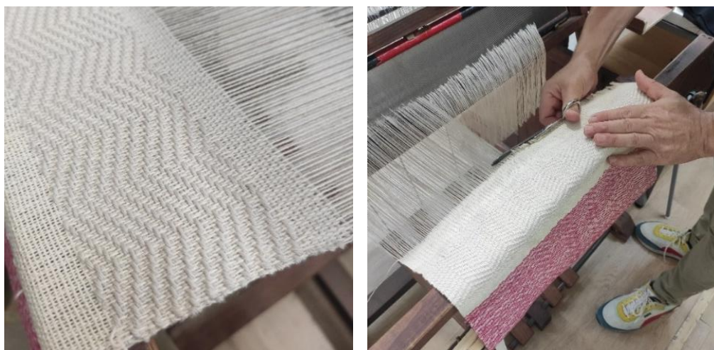
Figura 49 – Da esquerda para a direita: Experiência realizada para a escolha do padrão para a bolsa tear. Corte da experiência feita no tear. Fonte: Luana Silva.
