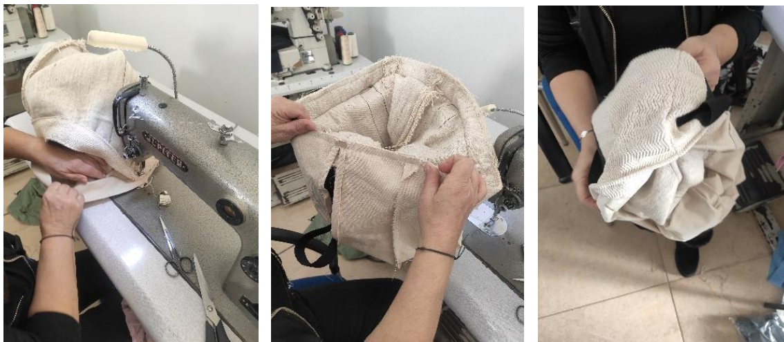
Figura 71 – Da esquerda para a direita: Costura dos moldes internos aos moldes externos. Bolsa do avesso. Virou-se a bolsa através da abertura. Fonte: Luana Silva.
