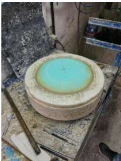
Figura 59 - Modelo fixo à base com barro e com desmoldante
