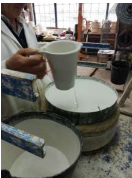
Figura 61 - Enchimento com gesso
