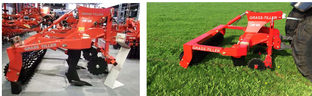
Figura 2.33 - Subsolador com disco de corte de erva e rolo regularizador. O disco corta a erva seca e garante a não acumulação de resíduos conforme o subsolador avança, enquanto o rolo regulariza a superfície do solo após a passagem
