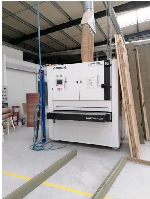
**Figura 23 - Lixadora/Calibradora (Foto da autora)**
