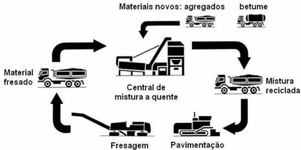
Figura 2.13: Esquema do processo de reciclagem a quente em central (Baptista, 2006)
