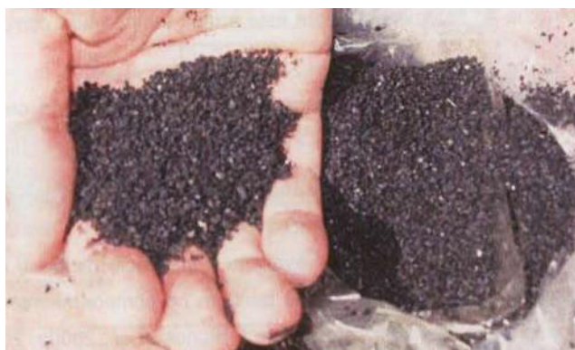
Figura 2.8: Borracha moída reciclada de pneu (Antunes et al, 2001c)
