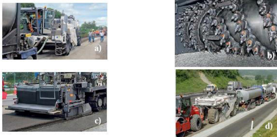
Figura 2.17: Alguns constituintes das máquinas recicladoras e comboio de reciclagem
