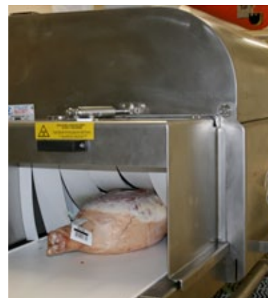
Figura 5: Sistema de inspeção por raios X (X2oV G90, Multiscan Technologies, SL, Cocentaina, Espanha) utilizado para determinar o teor de sal
