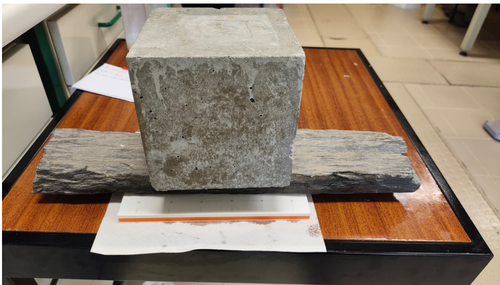
Figura 3.25. Molde fechado durante a cura, visível sob o conjunto de carga com bloco de betão.
