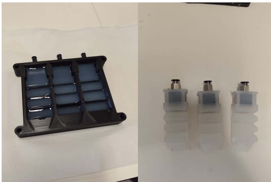
Figura 3.19. Moldagem e desmoldagem dos dedos pneumáticos.
