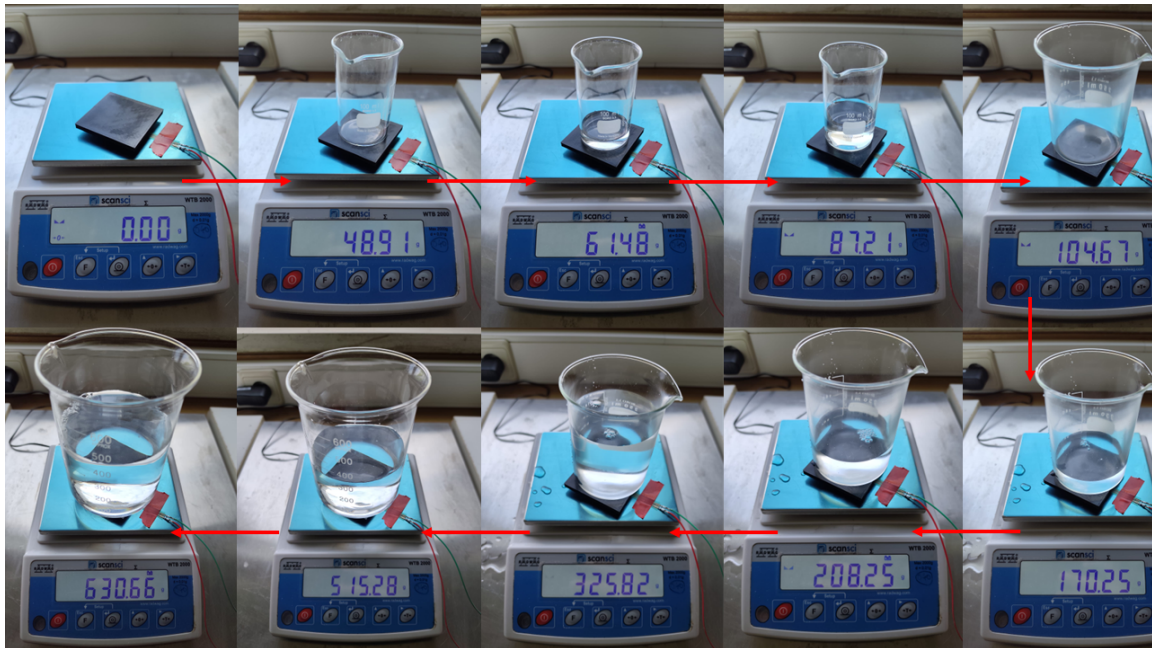
Figura 3.7. Processo de calibração dos sensores FSR.
