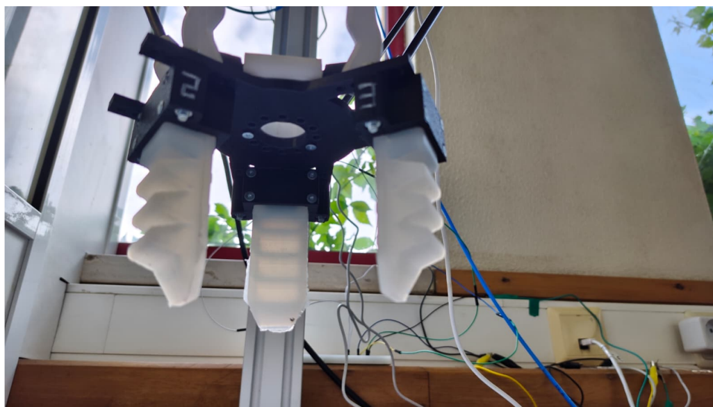
Figura 4.33. Montagem da garra no robô.
