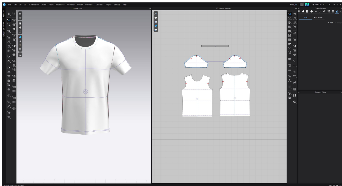
Figura 4.2: Criação da T-shirt no CLO3D, com visualização simultânea da peça em 3D e dos moldes bidimensionais utilizados na sua construção.
