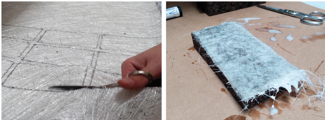
Figura 21: Da esquerda para a direita, recorte das várias camadas de fibra de vidro a utilizar na elaboração de provetes e prove de cortiça expandida combinado com fibra de vidro e resina epóxi pronto para a fase de cura.
