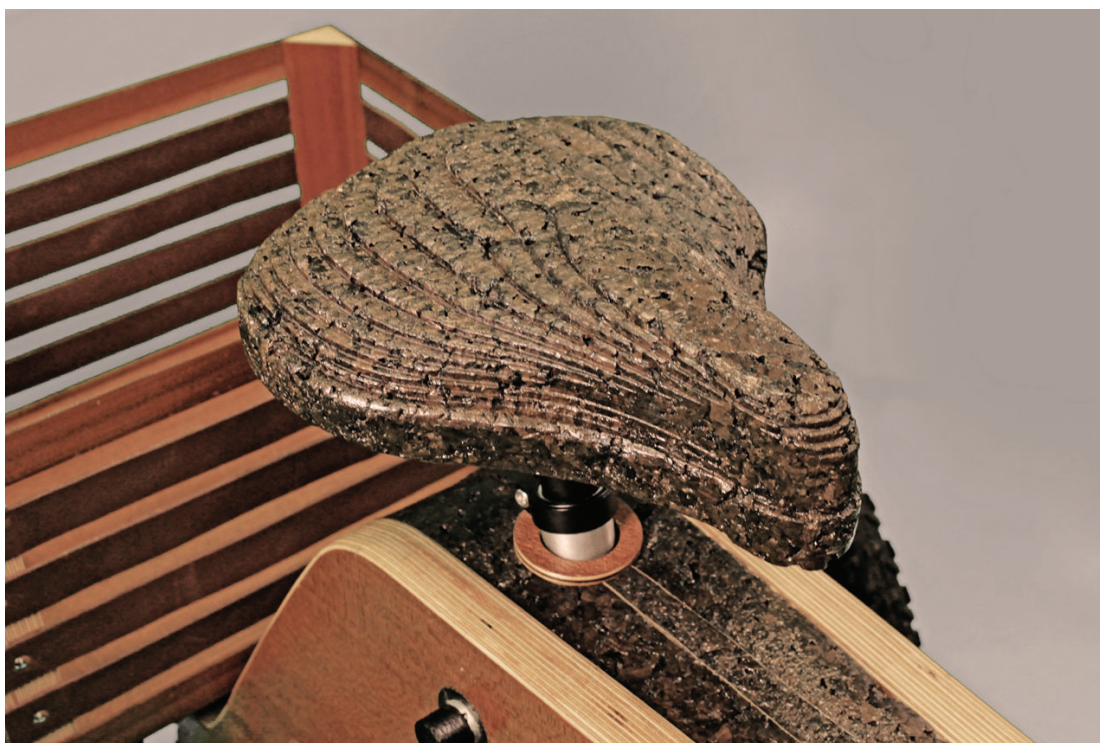
Figura 8: Imagem de detalhe do selim em cortiça expandida, idealizado para a tricicleta em madeira desenvolvida no âmbito do curso de Mestrado em Design Integrado (projeto RAIOOO)
