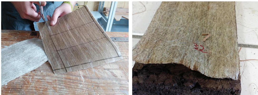
Figura 16: Da esquerda para a direita, corte do layout desenhado na fibra de linho e tipo de aplicação utilizada da fibra de linho nos provetes a elaborar.
