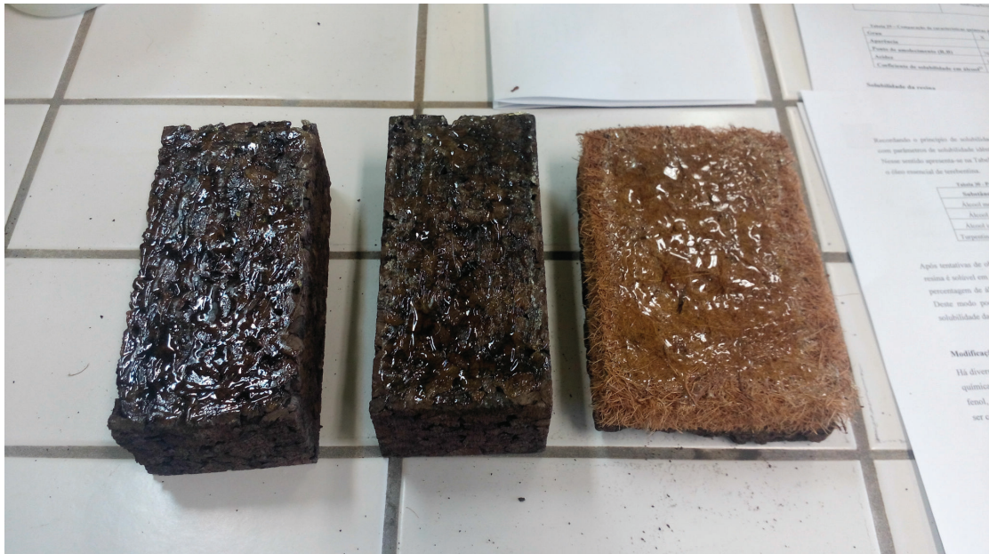
Figura 11: Resultado da aplicação de resina de colofónia nos provetes de cortiça expandida Standard, MDF e provete de fibra de coco.
