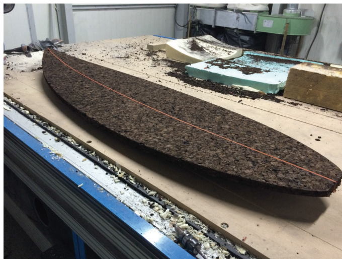
Figura 47: Resultado final da fase de maquinação em CNC da prancha de surf em cortiça
