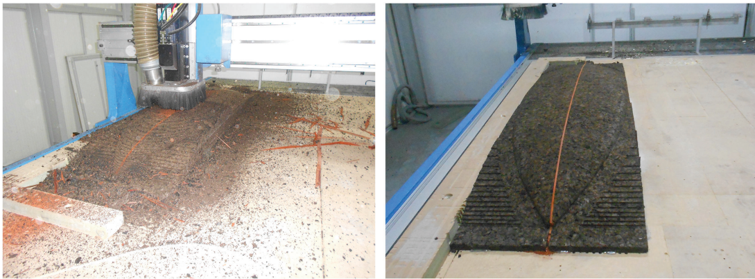
Figura 44: Da esquerda para a direita, corte de desbaste e, parte inferior da prancha após corte de acabamento.
