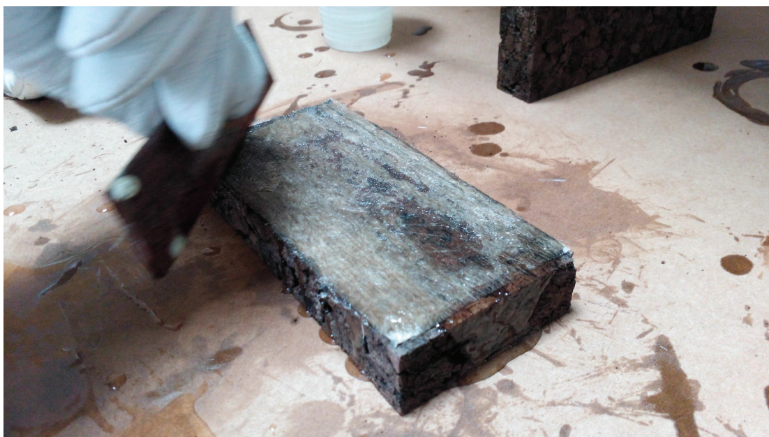
Figura 20: Aplicação de resina epóxi convencional sob fibra de linho em cortiça expandida.
