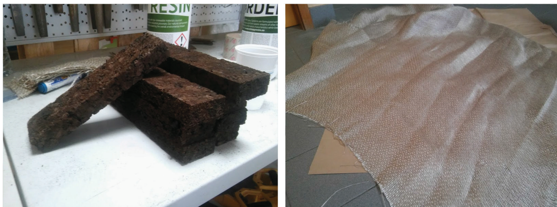
Figura 25: Provetes maquinados a partir de bloco de cortiça expandida HD e tecido de fibra de linho a ser utilizado.
