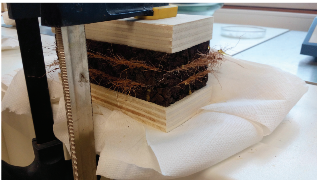
Figura 14: Solução de laminados prensada através do uso de grampos, escoando excessos de resina e reforçando a ligação entre elementos.
