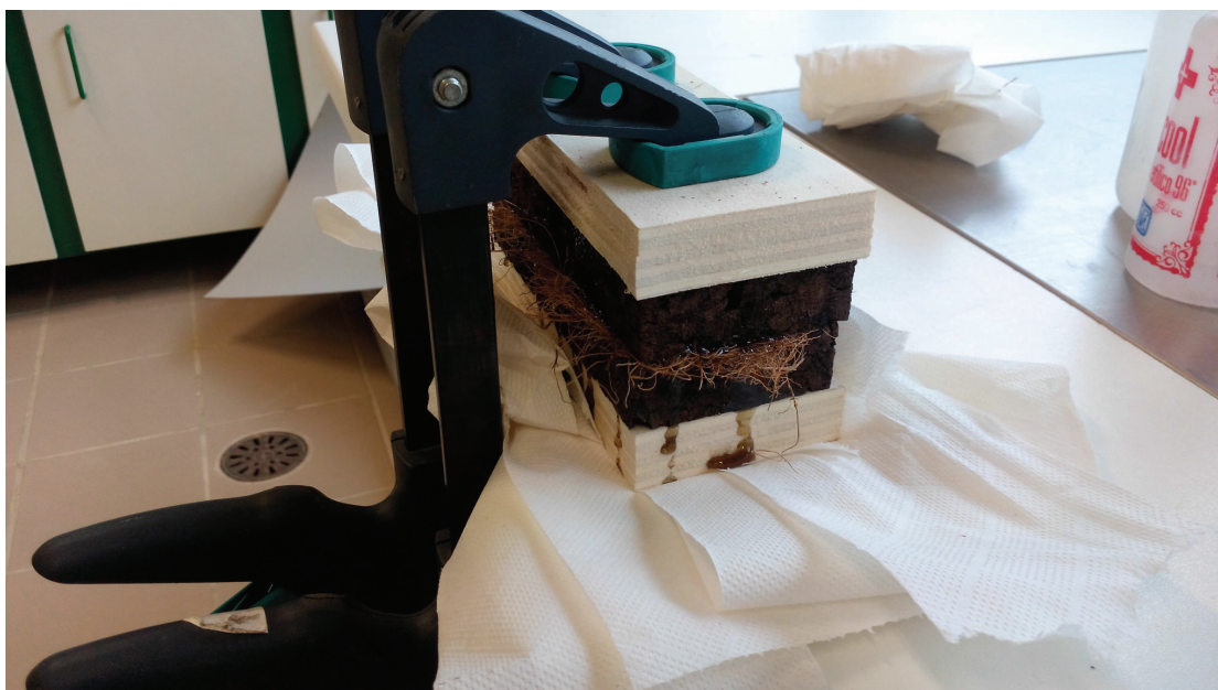
Figura 13: Solução de laminados prensada através do uso de grampos, escoando excessos de resina e reforçando a ligação entre elementos.
