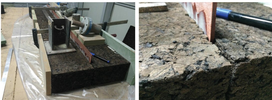
Figura 42: Colagem de blocos de cortiça juntamente com longarina, prensados com grampos.
