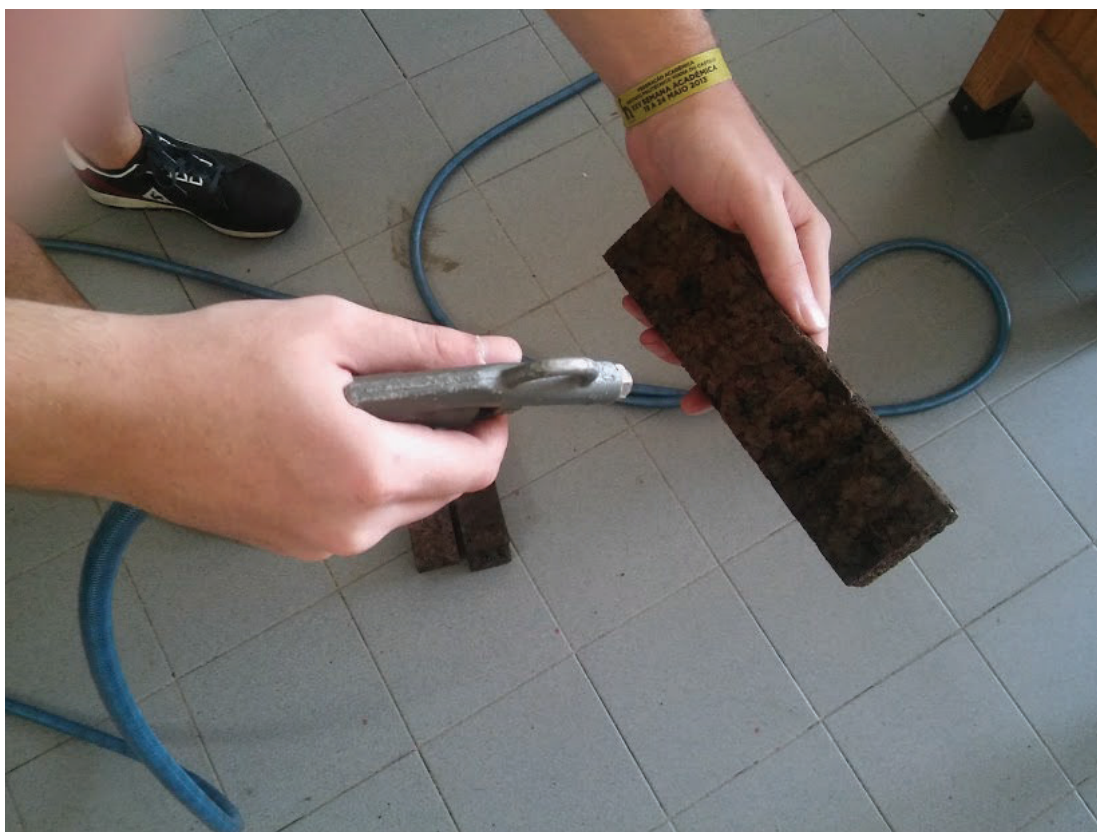
Figura 28: Utilização de compressor para limpar qualquer tipo de lixos ou pós que pudessem interferir no momento de ligação entre fibra de linho e cortiça.
