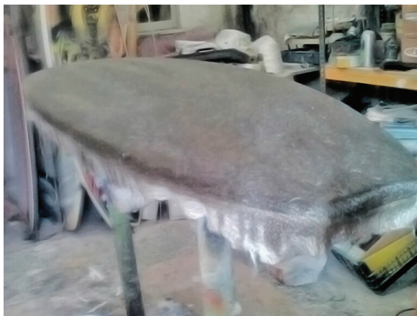
Figura 48: Aplicação de fibra de linho na parte inferior do protótipo final.
