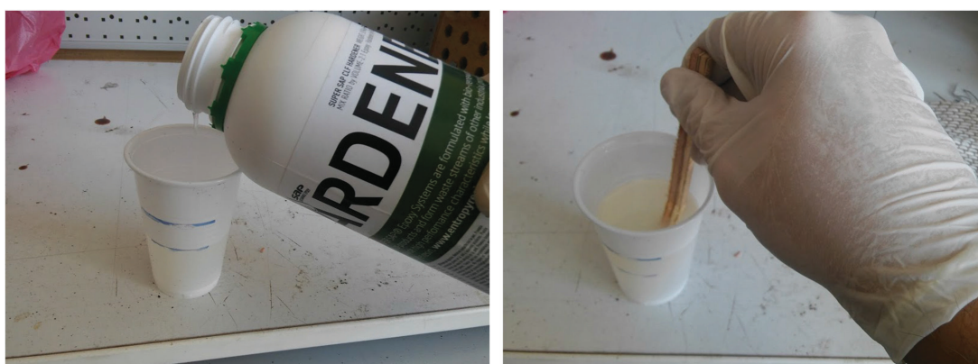
Figura 29: Da esquerda para a direita, medição de quantidades pretendidas de resina e endurecedor e mistura da resina com o endurecedor.
