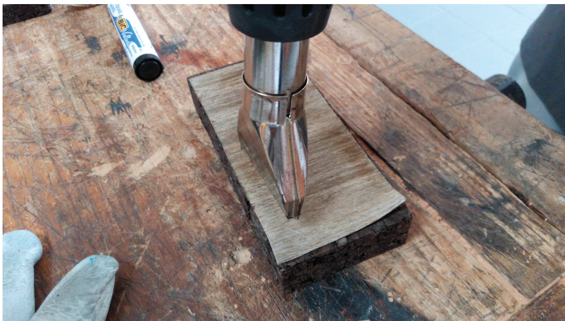
Figura 17: Processo utilizado para ligar a fibra de linho com o bloco de cortiça expandida.
