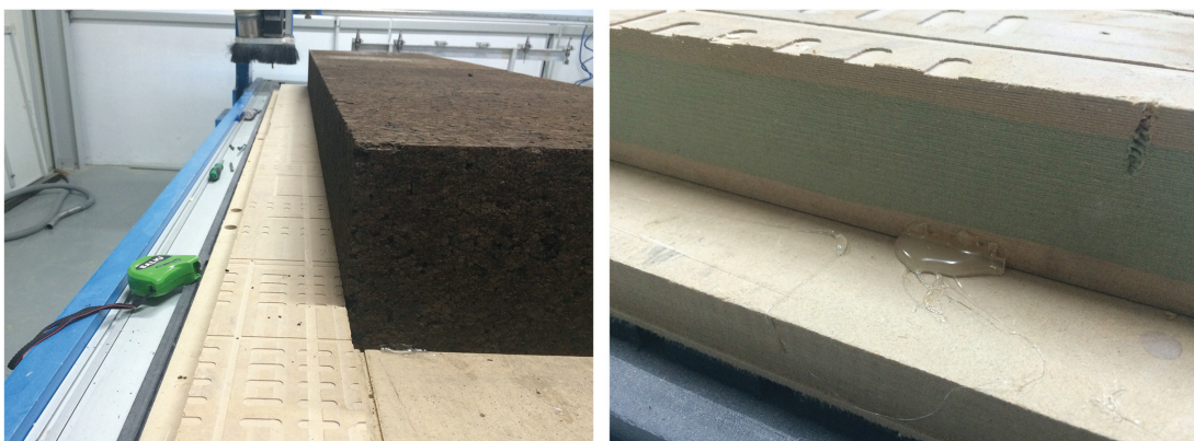
Figura 37: Da esquerda para a direita, esquadria feita para alinhar os blocos de cortiça de acordo com o software e, régua de madeira fixada com cola quente para evitar movimentos desnecessários durante maquinação
