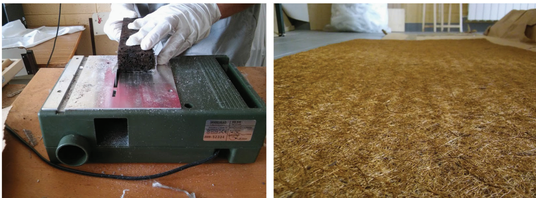
Figura 31: Da esquerda para a direita, utilização de máquina de corte para limar excessos de camadas de fibra de linho e placa de fibra de coco prensada com espessura de 10mm.
