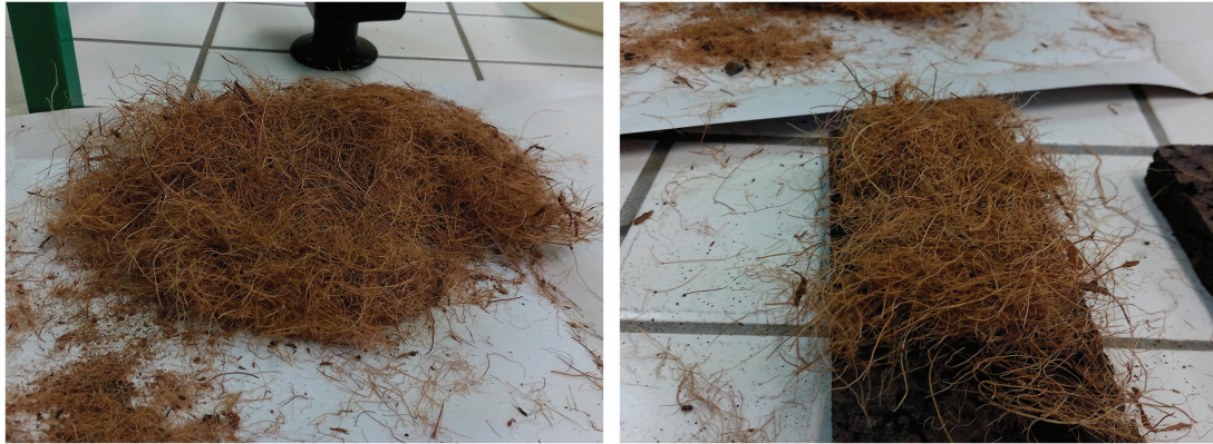
Figura 12: Da esquerda para a direita, a fibra de coco após ser retirada de um bloco Corkoco e o método de manuseamento da fibra de coco quando utilizada em solução de laminados.
