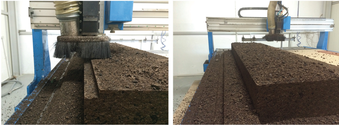
Figura 38: Desbaste dos blocos em cortiça expandida HD para permitir corte no eixo central a vaziar os blocos e também um nivelamento dos topos.
