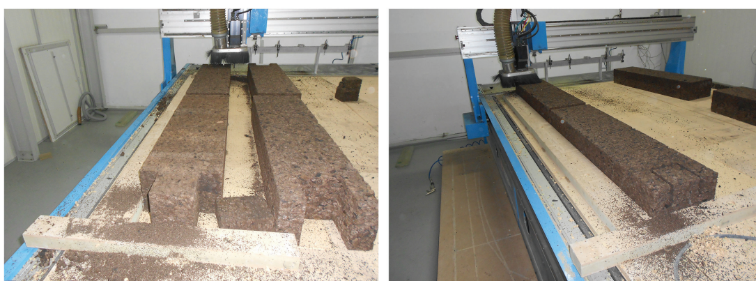
Figura 40: Maquinação de dentes de encaixe para unir blocos de cortiça.
