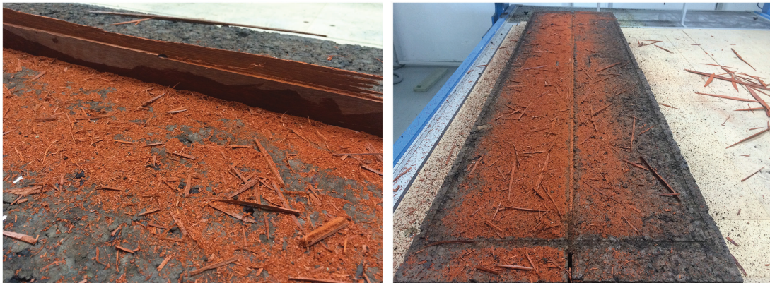
Figura 43: Da esquerda para a direita, desbaste da longarina e, marcação de esquadria no bloco de cortiça preparado.
