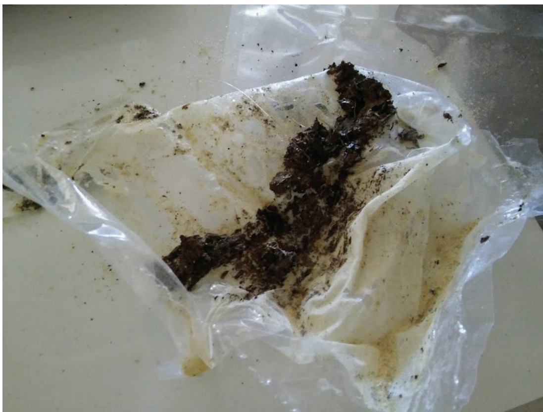
Figura 24: Restos de cortiça expandida que acabaram por ficar colados ao plástico no momento de extração do provete.
