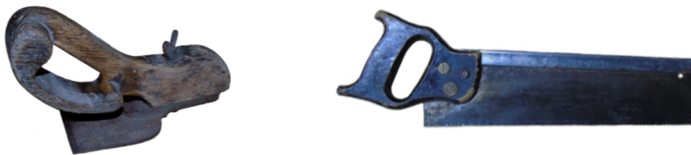
Figura 7 - Da esquerda para a direita: Enxó e Serrote Manual 43
