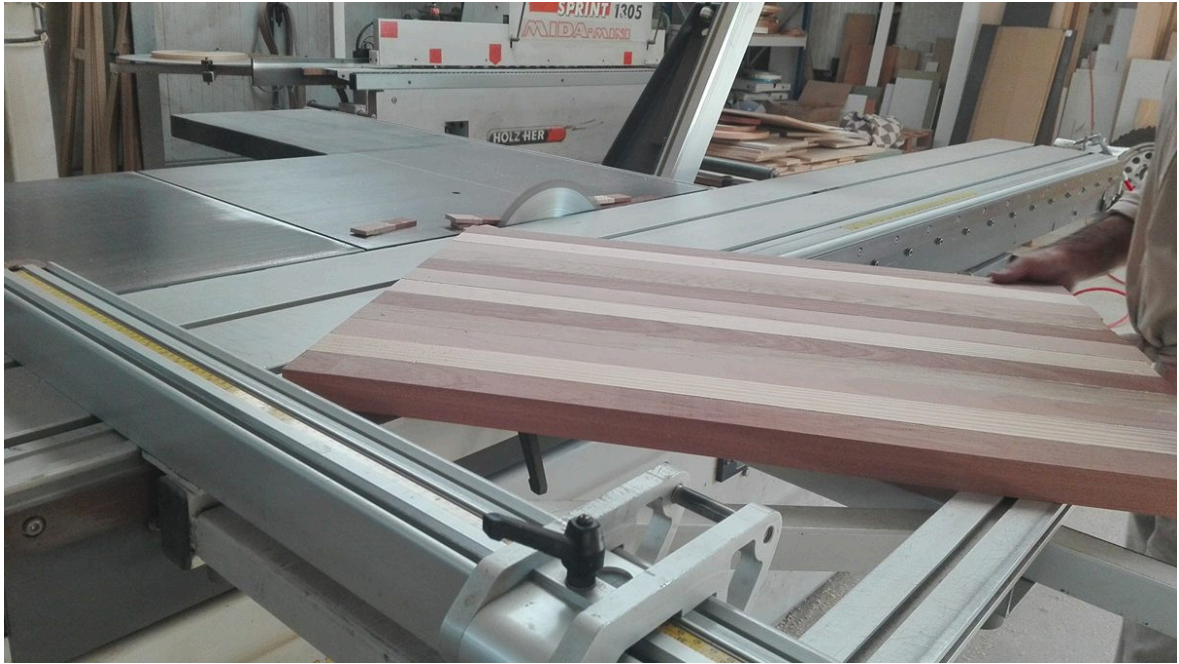
Figura 82 - Corte da placa à esquadria. 160
