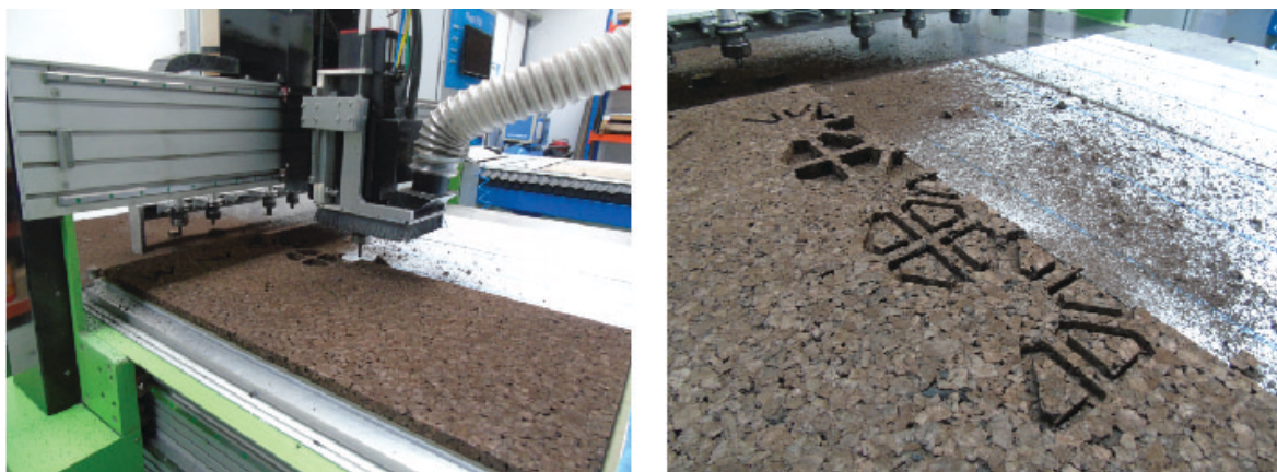
Figura 72 - Da esquerda para a direita: Maquinação da Cortiça em CNC. 150
