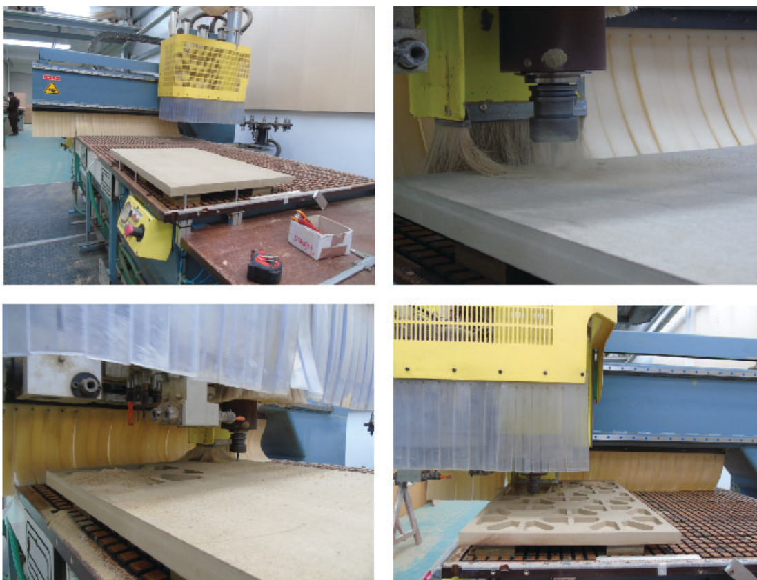
Figura 75 - Da esquerda para a direita de cima para baixo: Maquinação do MDF na CNC. 153
