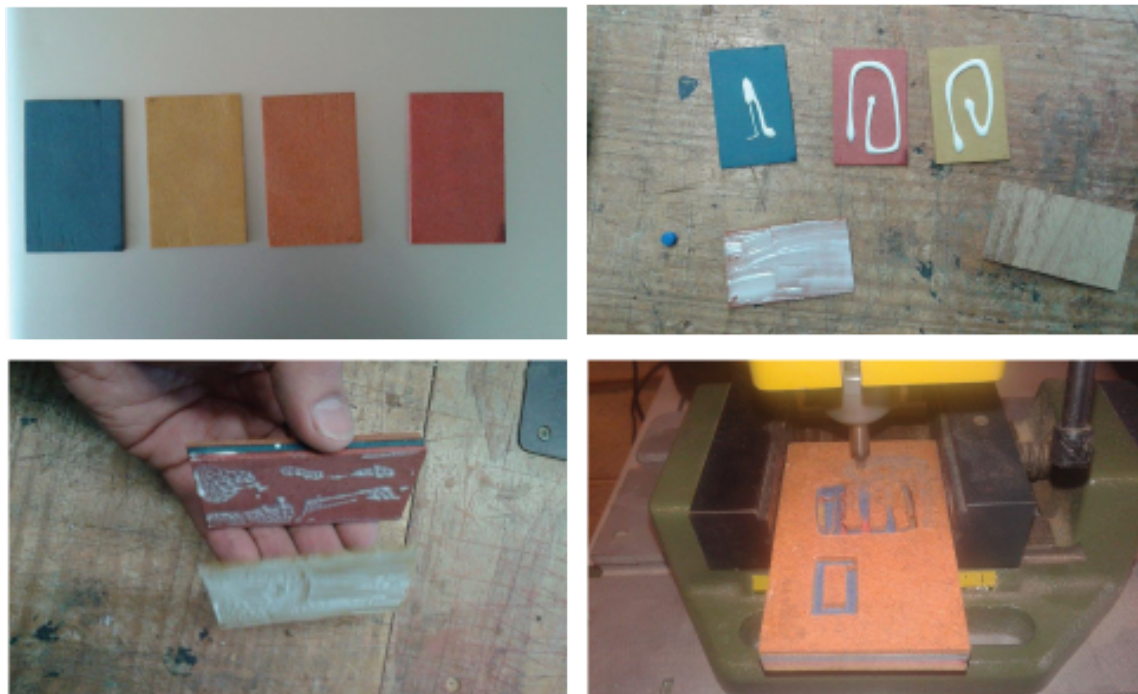
Figura 34 - Da esquerda para a direita e de cima para baixo: Corte das peças. Colagem das peças. Junção das peças. Fresagem da peça. 110
