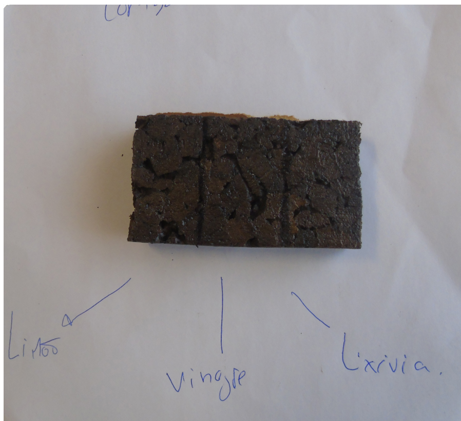
Figura 49 - Aplicação de verniz na cortiça 127
