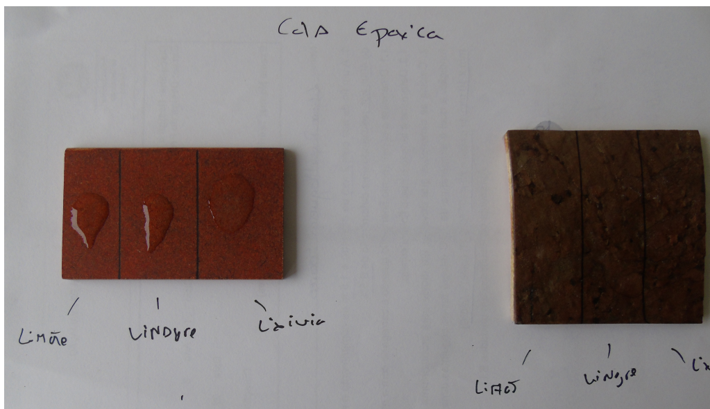
Figura 41 - Aplicação de substâncias químicas na cola epóxi. 119
