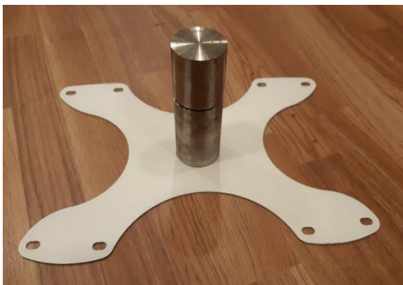
Figura 56: Molde do encaixe das cadeiras com peça giratória. Fonte: Autores.
