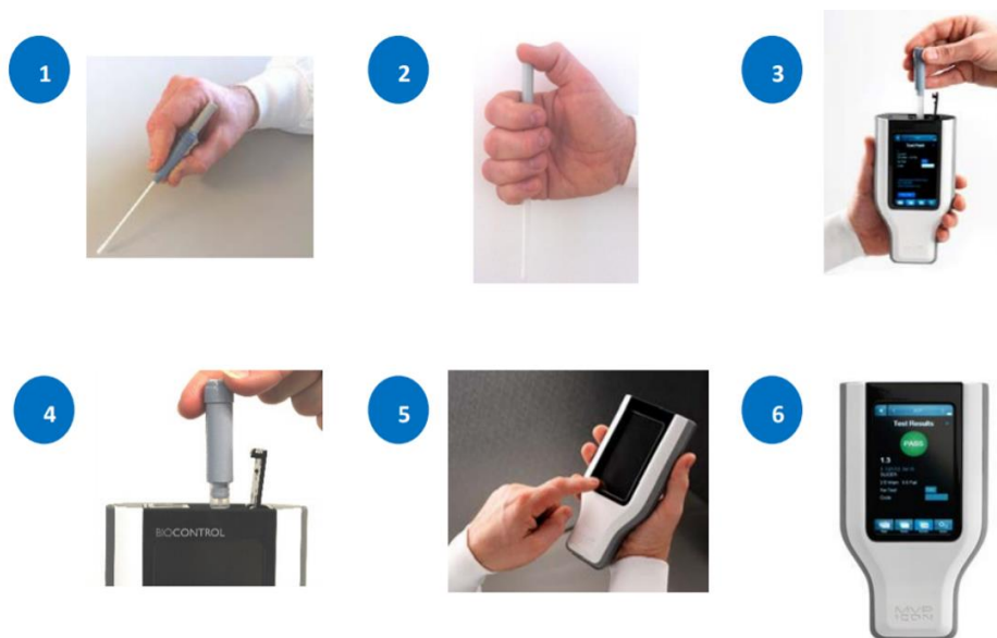
Figura 7 - Procedimento de execução do teste de ATP utilizado [19]
