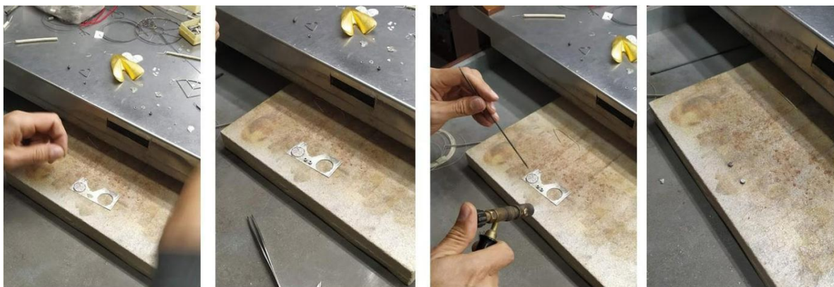
Figura 101- Momento de soldadura para fechar um dos lados dos componentes criados. Fonte: Anaïs ROLO
