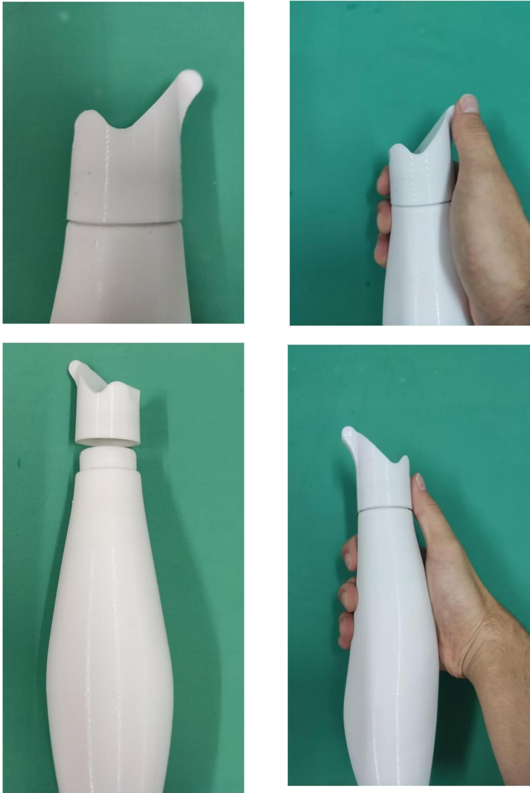
Figura 38 - Testes de usabilidade com o primeiro protótipo em impressão 3D industrial
