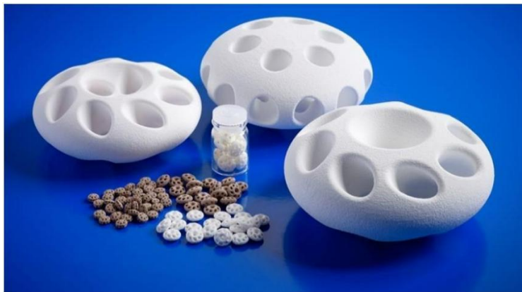
Figura 27 Impressão por Binder Jetting de peças cerâmicas Fonte: 3dprint.com
