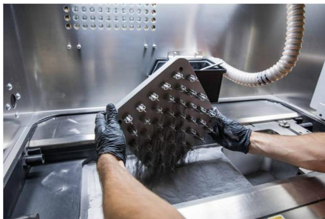
Figura 24 Impressão por DMLS Fonte: beamler.com
