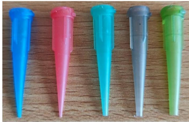
Figura 56 Pontas para a cabeça de extrusão. Fonte: Rafael Rocha
