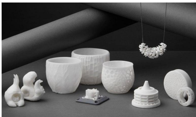
Figura 28 Impressão por SLA/DLP de peças cerâmicas Fonte: 3dnatives.com
