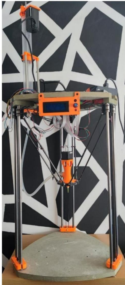
Figura 58 Versão final da impressora de cerâmica, projetada para este trabalho de tese. Fonte: Rafael Rocha
