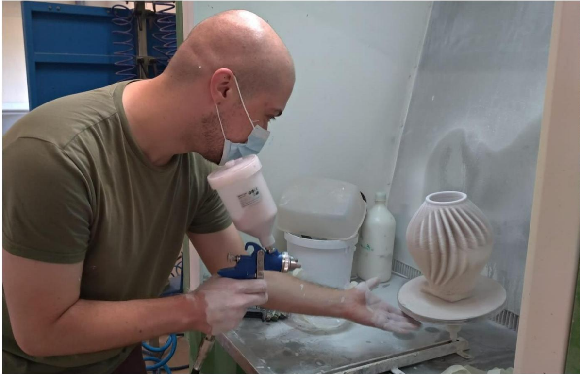
Figura 198 Processo de vidragem a pistola da jarra. Fonte: Rafael Rocha
