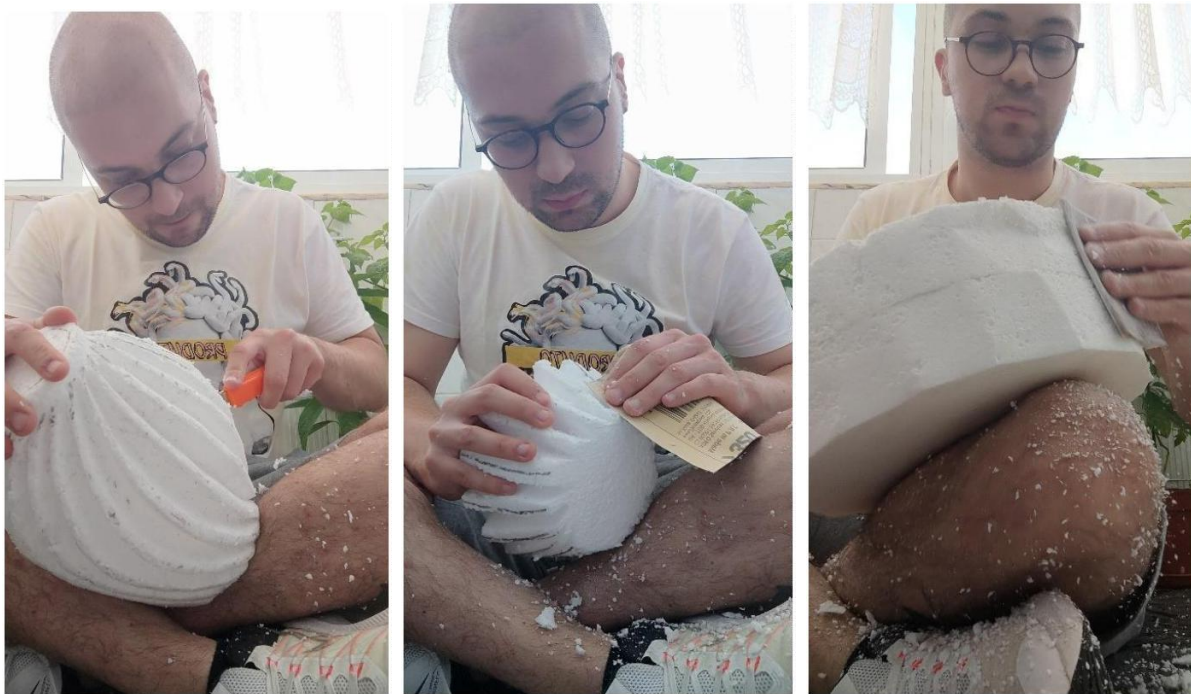
Figura 180 Processo de produção dos modelos em esferovite (Jarra, porta-velas e centro de mesa, nomeadamente). Fonte: Rafael Rocha
