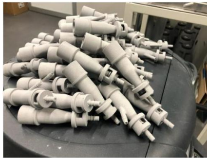
Figura 16 Válvulas para ventiladores impressos em 3D Fonte: Interreg-central.eu
