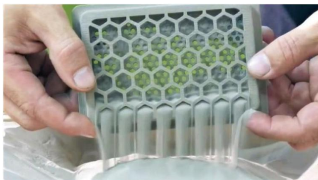
Figura 25 Impressão por Binder Jetting Fonte: all3dp.com
