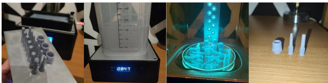
Figura 57 Processo de produção das pontas, impressão/lavagem/cura e resultado final. Fonte: Rafael Rocha
