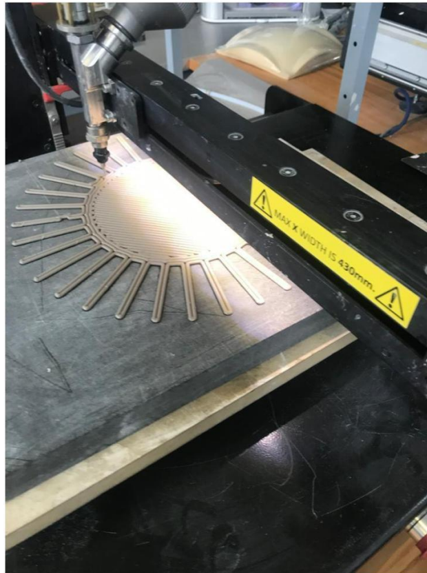
Figura 189 Impressão da primeira camada do centro de mesa Fonte: Rafael Rocha
