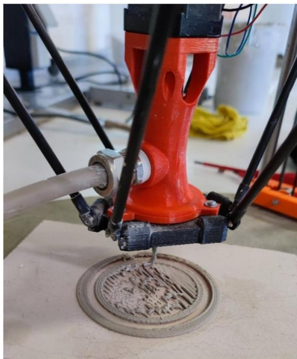
Figura 156 Teste de impressão, com falhas na continuidade do fio de pasta extrudida Fonte: Rafael Rocha
