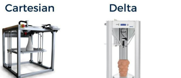
Figura 29 Impressora cartesiana e impressora delta Fonte: aniwaa.com
