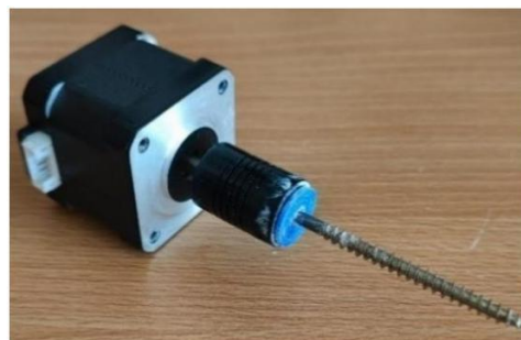
Figura 51 Novo motor Nema 23 da cabeça de extrusão com parafuso helicoidal acoplado. Fonte: Rafael Rocha
