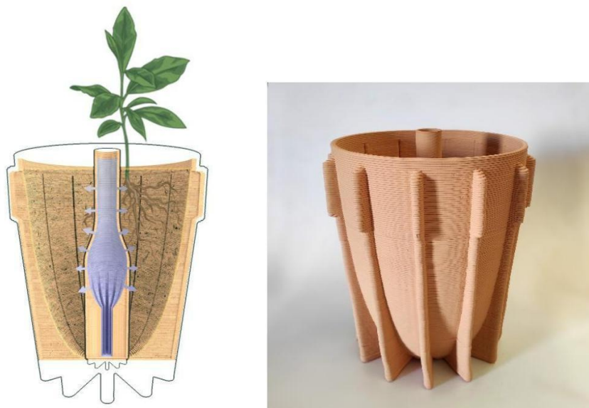
Figura 63 Desenho do vaso “OLLA” em funcionamento e vaso “OLLA” impresso. Fonte: Jetclay.com
