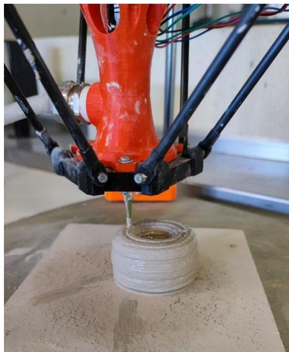
Figura 157 Teste de impressão com excesso de extrusão Fonte: Rafael Rocha
