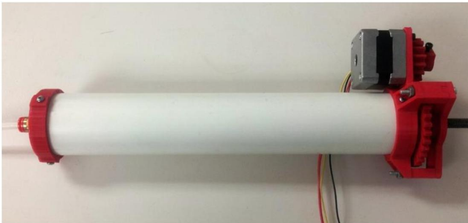
Figura 44 Sistema de alimentação mecânico desenvolvida por Adam Kemp Fonte: thingiverse.com
