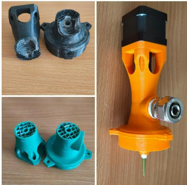
Figura 49 Cabeça de extrusora em PLA (preto) / cabeça da extrusora em ABS (verde) / cabeça da extrusora em PETG (laranja). Fonte: Rafael Rocha
