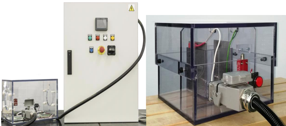
Figura 9. Equipamento PEF (à esquerda) e pormenor da câmara de tratamento fechada para processamento em batch.
