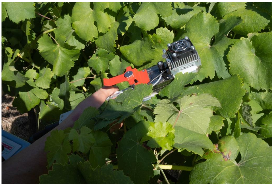
Figura 19 - Realização da leitura com o equipamento IRGA
