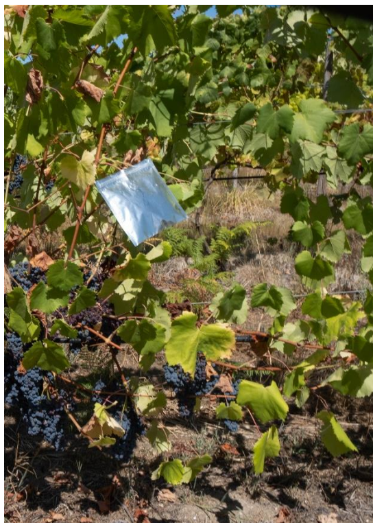
Figura 17 - Colocação do saco de alumínio na folha, para a medição do potencial hídrico de ramo
