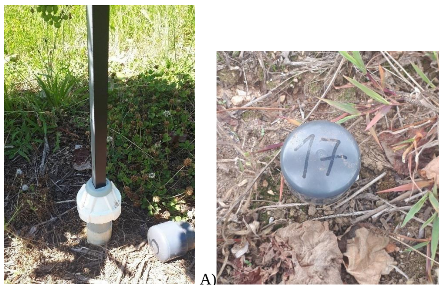
Figura 3.8 - Monitorização da água no solo: A) sonda portátil Diviner 2000; B) tubo de acesso em PVC.
