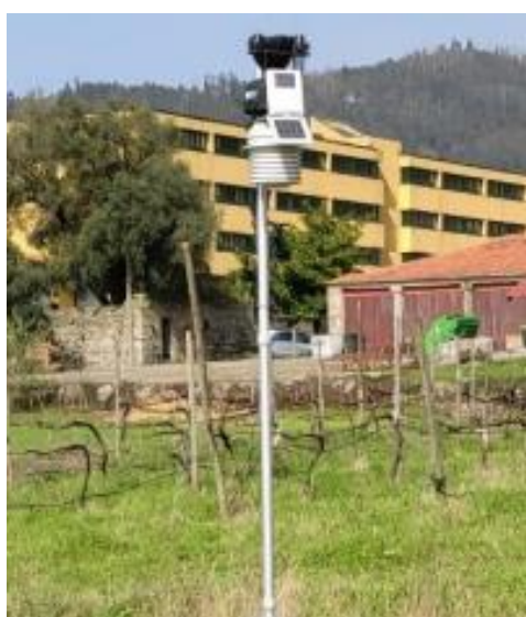
Figura 3.5 - Estação meteorológica instalada na ESA-IPVC para registo diário de dados climáticos.
