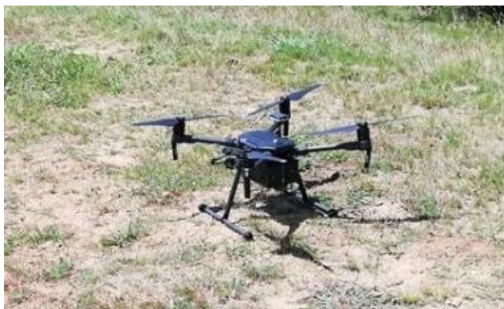
Figura 2.9 - Veículo aéreo não tripulado (VANT), com câmara, utilizado para a obtenção de imagens aéreas.
