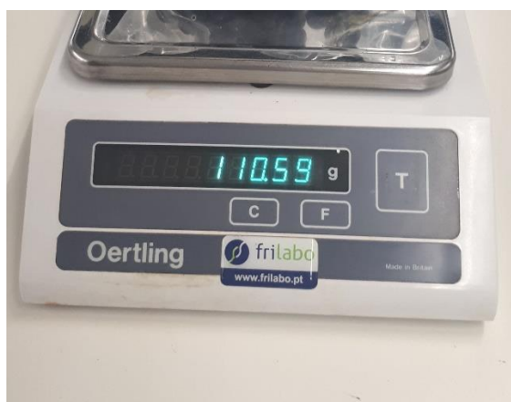
Figura 3.14 – Balança para a pesagem dos bagos e dos cachos para posterior cálculo do rendimento por estratégia de rega.
