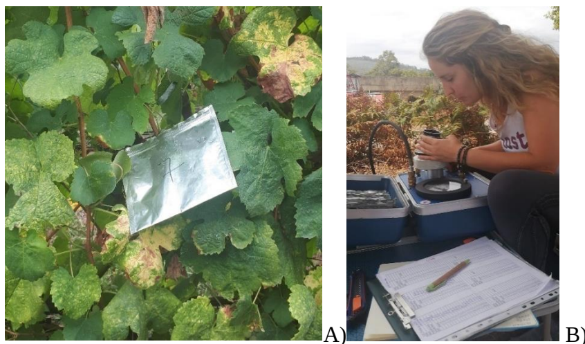
Figura 3.9 – Determinação do potencial hídrico: A) instalação dos sacos para a medição do potencial do ramo; B) medição dos potenciais através da câmara de pressão Scholander.
