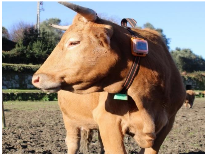
Figura 2.4. Bovino con dispositivo de rastreo GPS en collar.
