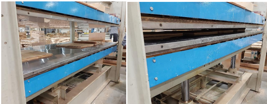
Figura 39: Da esquerda para a direita: prensa com três placas prontas para serem prensadas, na direita a prensa está a ser comprimida para finalizar o processo
