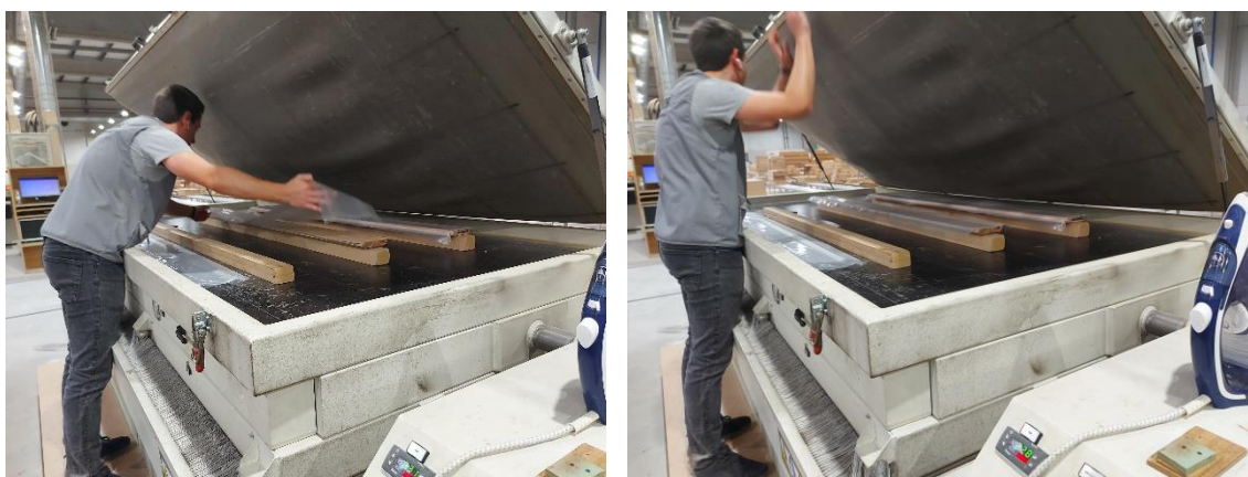
Figura 40: Da esquerda para a direita: o operário a colocar o plástico por cima das placas com a folha de madeira, na direita o operário a fechar a prensa a vácuo para finalizar o processo.
