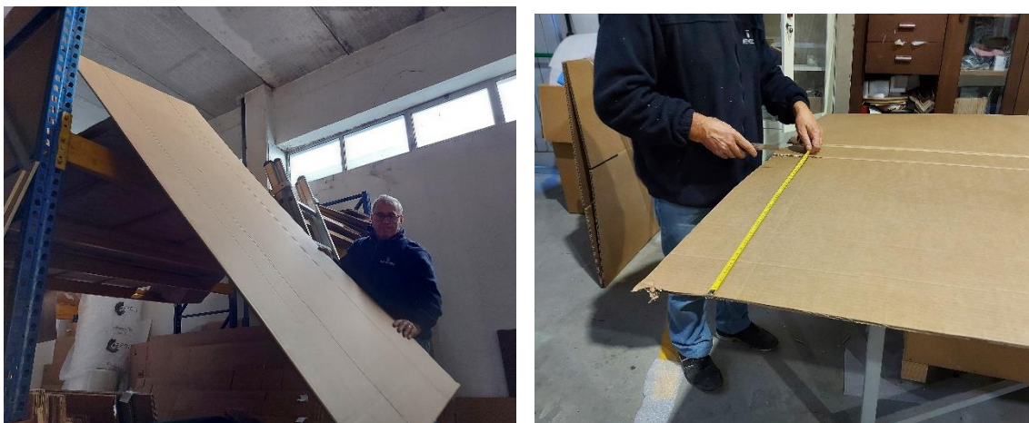
Figura 29: Da esquerda para a direita: Na esquerda o Sr. Mariano escolheu o cartão necessário para formar a caixa, na direita cortou na medida certa para que as dimensões externas sejam respeitadas, fazendo com que a peça não se movimente dentro da mesma.
