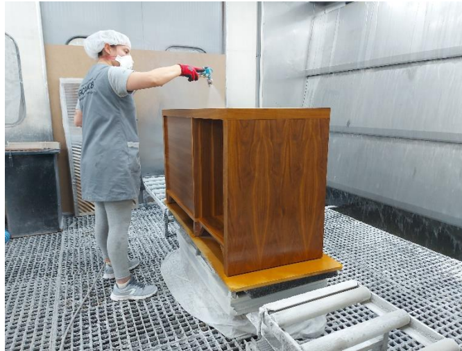
Figura 28: Aplicação da velatura com pistola no mobiliário
