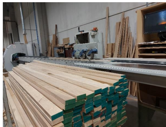
Figura 22: Da esquerda para a direita: o operário a colocar a madeira já marcada na otimizadora para a triagem, na direita a madeira já está cortada e pronta para passar para a fase seguinte.
