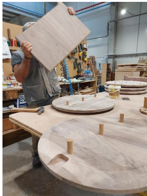
Figura 26: Da esquerda para a direita: a cavilhas estão colocadas nas aberturas, na direita a placa central está a ser colocada com a ajuda de cola branca e das cavilhas.
