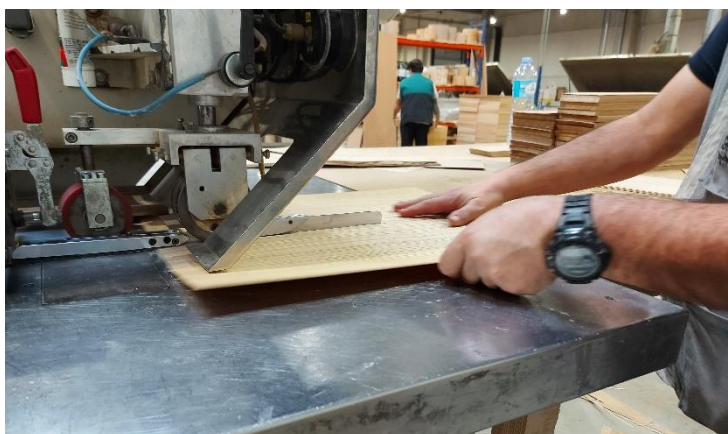
Figura 37: Marceneira a manusear as folhas de madeira para serem coladas com o método de colagem em linha
