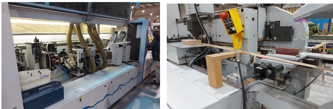
Figura 41: Da esquerda para a direita: Interior da máquina Orladora Homag, na direita a Orla que ira ser colocada na placa de contraplacado marítimo
