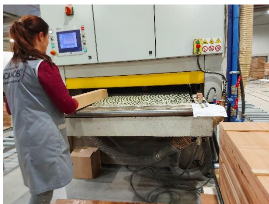
Figura 23: Da esquerda para a direita, operária a colocar a ripa na calibradora e na direita operária a receber a ripa de madeira para colocar novamente empilhada para passar para a próxima fase.
