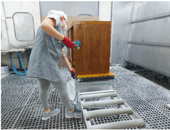
Figura 89: Aplicação da velatura
