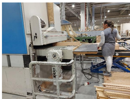
Figura 23: Da esquerda para a direita, operária a colocar a ripa na calibradora e na direita operária a receber a ripa de madeira para colocar novamente empilhada para passar para a próxima fase.
