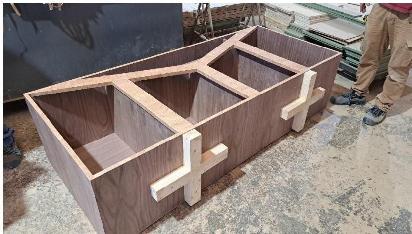
Figura 57- Pés do aparador em forma de cruz para uma melhor estabilidade do móvel (Foto: Autora.)
