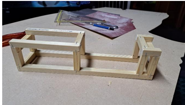
Figura 86- Estrutura interior criada para o Móvel TV. (Foto: Autora.)
