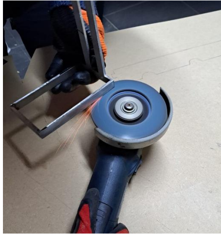
Figura 88- Processo de rebarbar as peças de inox. (Foto: Autora.)
