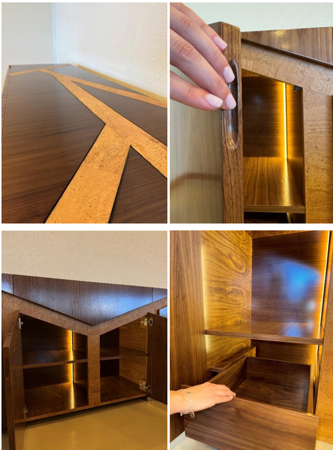
Figura 98- Detalhes do protótipo. Canto superior esquerdo: Pormenor do detalhe em cortiça no tampo. Canto superior direito: Detalhe da ranhura que facilita a abertura de porta. Canto inferior esquerdo: Vista interior do protótipo focando na iluminação interior. Canto inferior direito: Vista interior do aparador, com destaque a prateleira e a gaveta interior. (Foto: Autora.)
