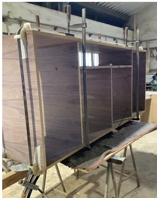
Figura 58- Processo desenvolvido para a construção da estrutura do aparador. (Foto: Facebook Atitude.)
