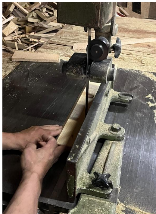
Figura 91: Da esquerda para a direita: Corte na serra de fita das tabuas com 100mm e 80mm.
