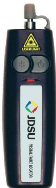
Figura 24: Fonte de luz visível. Fonte: dstelecom.
