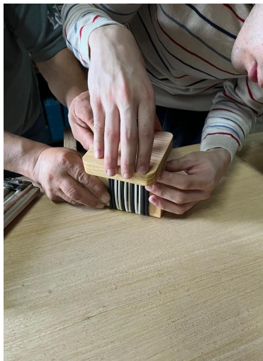
Figura 95: Da esquerda para a direita: Agrafagem dos cabos à grelha e fixação da base à grelha do módulo de suporte de telemóveis.
