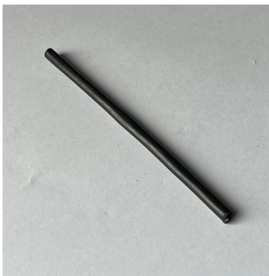
Figura 53: Camada externa do cabo (LSZH).
