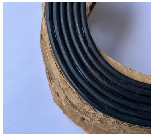
Figura 62: Teste de aplicação do cabo de fibra ótica como material antiderrapante na base do produto.
