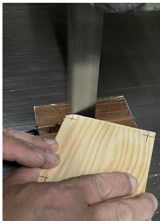
Figura 92: Da esquerda para a direita: Desbastação das ripas para construção da grelha na garlopa desengrossadeira e arredondamento da base do módulo para suporte de telemóveis.
