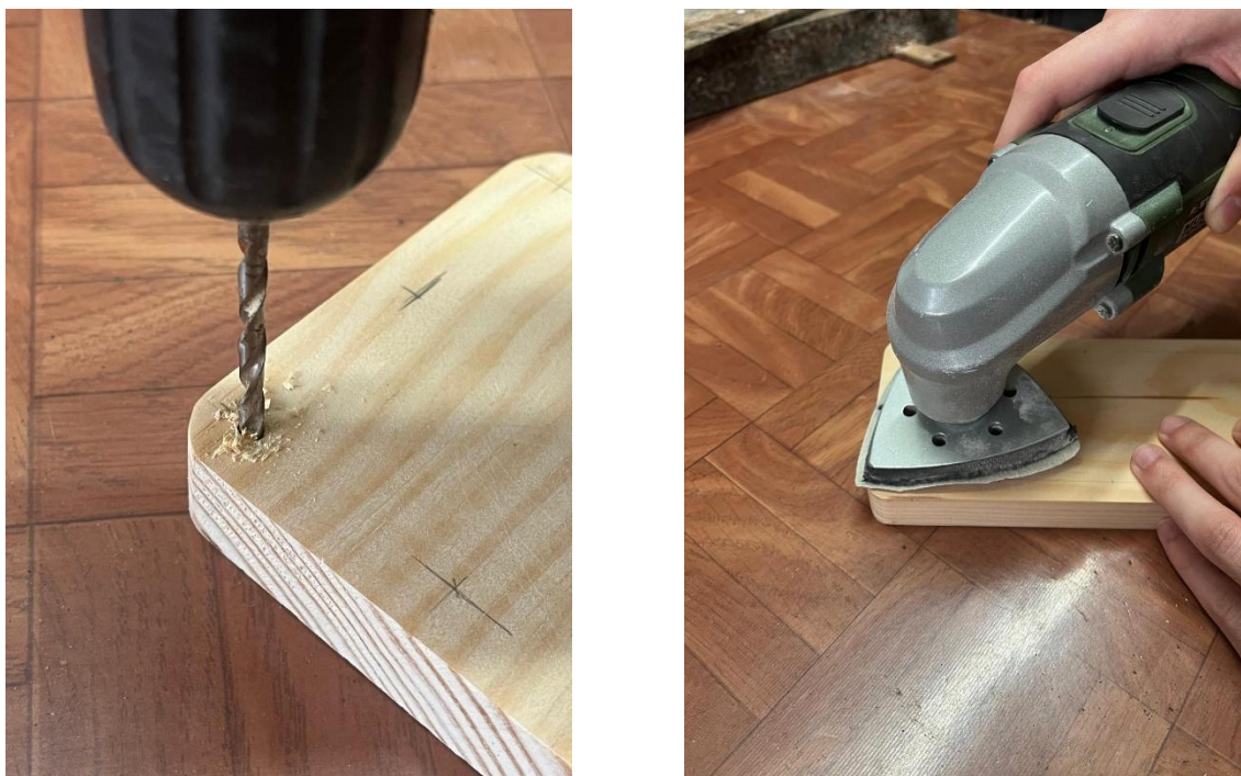
Figura 98: Da esquerda para a direita: Furação dos orifícios de 10 mm na base do cesto multiusos e lixamento da peça.
