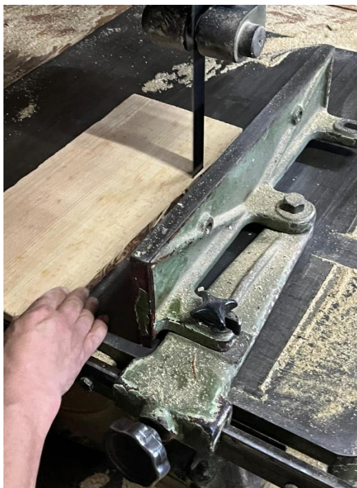
Figura 91: Da esquerda para a direita: Corte na serra de fita das tabuas com 100mm e 80mm.
