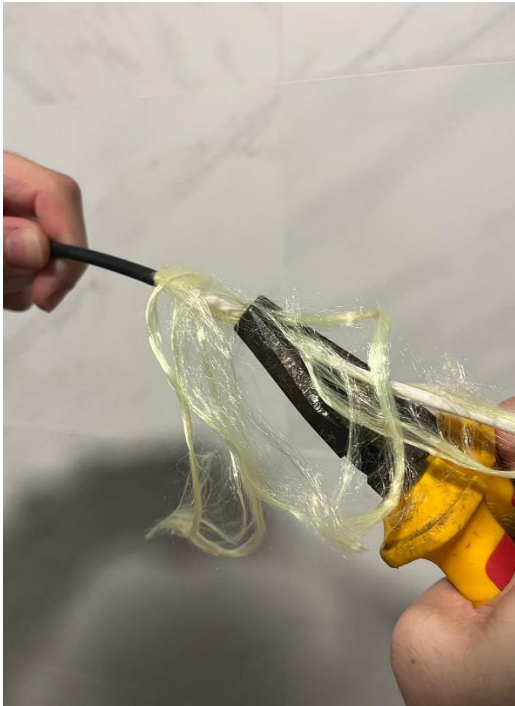
Figura 99: Da esquerda para a direita: Desconstrução do cabo de fibra óptica e separação da camada externa do cabo e do tensor (cabo branco). Colocação do tensor dentro do cabo preto com o uso de kevlar de forma a criar um “cabo sem fim”.
