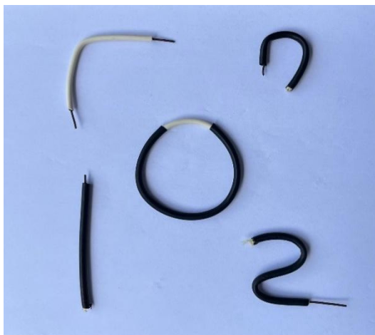
Figura 61: Teste de reforço estrutural do cabo de fibra ótica com fios de aço recozidos.
