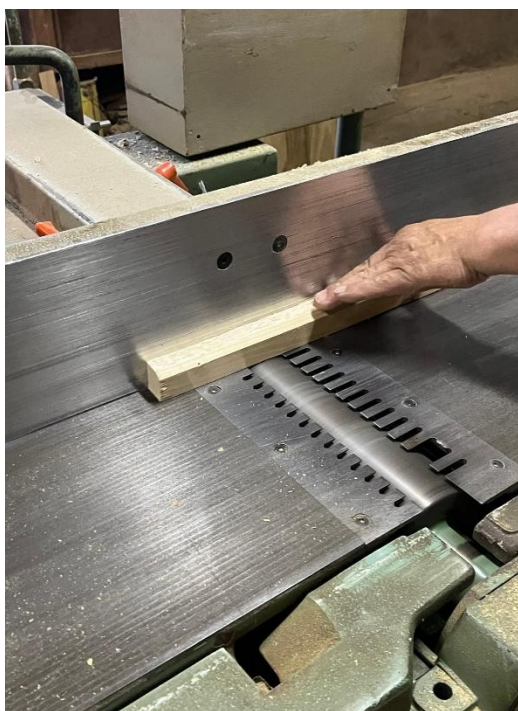
Figura 92: Da esquerda para a direita: Desbastação das ripas para construção da grelha na garlopa desengrossadeira e arredondamento da base do módulo para suporte de telemóveis.
