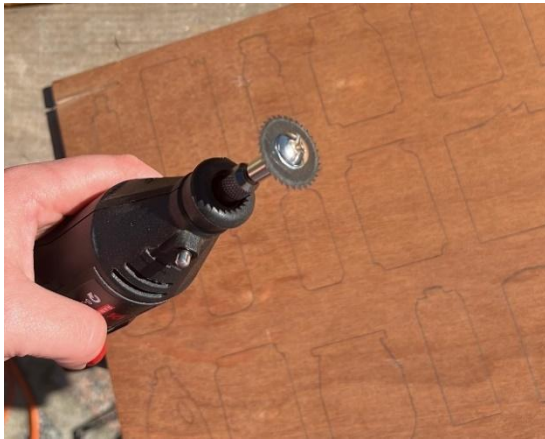
Figura 76 - Desenho dos resíduos e pequeno disco de serra circular. (Fonte: Autores)
