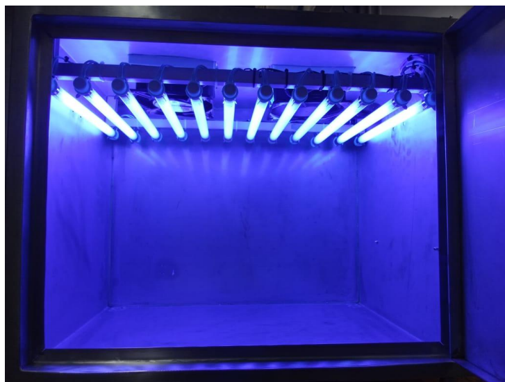
Figura 8. Câmara de radiação ultravioleta utilizada no ensaio de fotocatalise sob irradiação UV.
