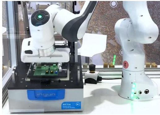
Figura 4 - Robôs colaborativos Ingun em tarefas repetitivas e não ergonômicas. (Ingun)
