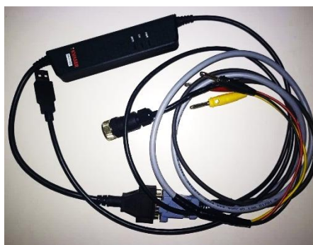
Figura 13 - Interface Kvaser com conetores de alimentação e ligação ao PCBA
