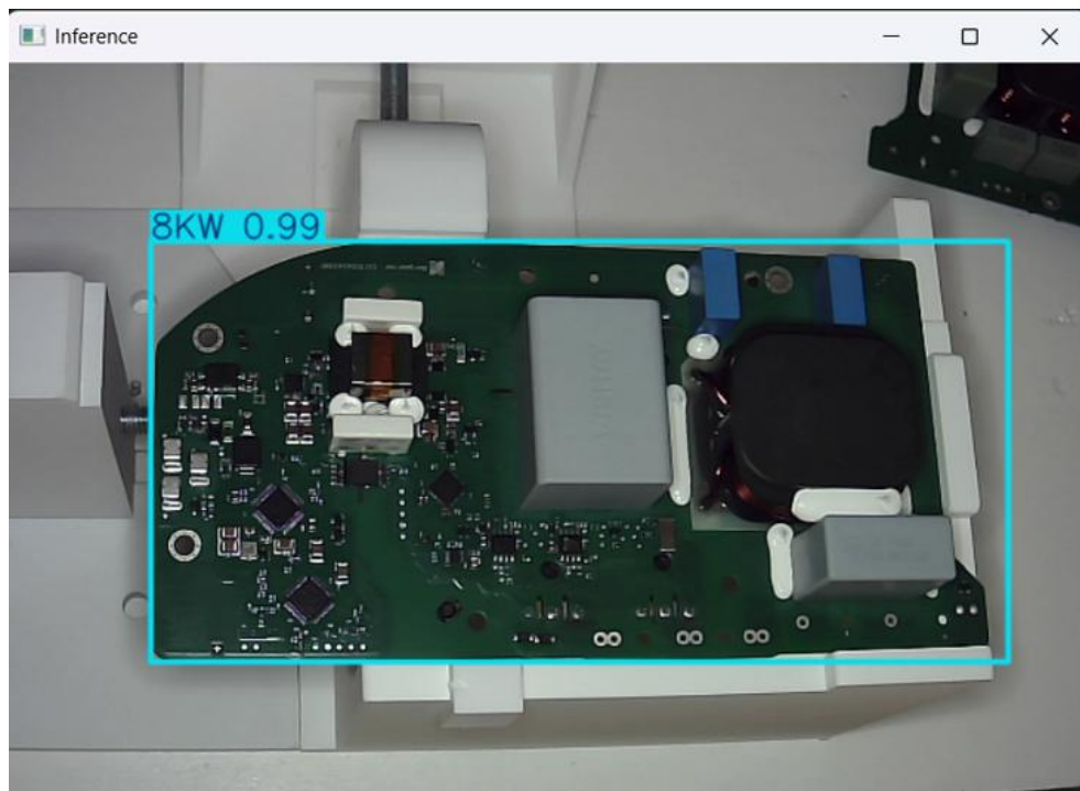
Figura 60 - PCBA de 5.2KW identificada como 8KW
