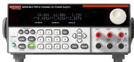
Figura 12 - Fonte de alimentação Keithley 2231A-30-3, (Keithley)
