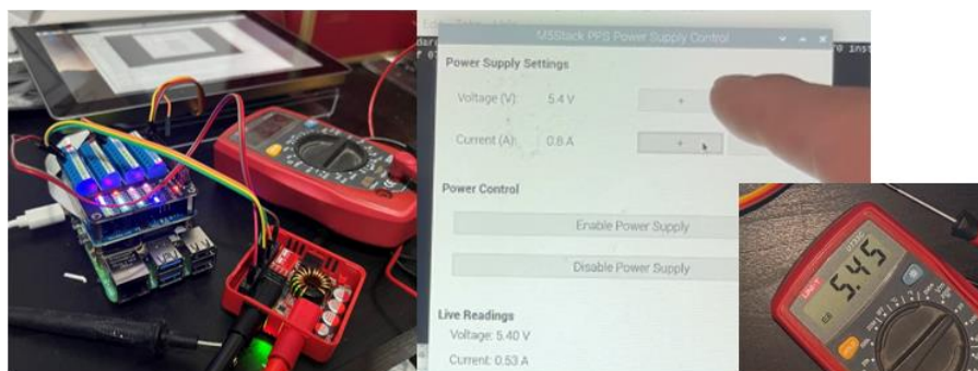
Figura 30 - Teste experimental do módulo M5Stack PPS
