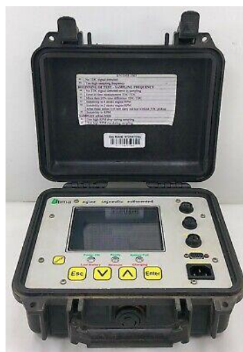
Figura 11 - Exemplo de sistema de diagnostico portátil (Ultima EDI Engine Diagnostic Instrument)
