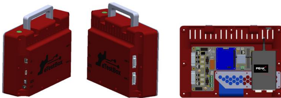
Figura 39 - Vista exterior e interior do Chassis Integrado da eTestBox
